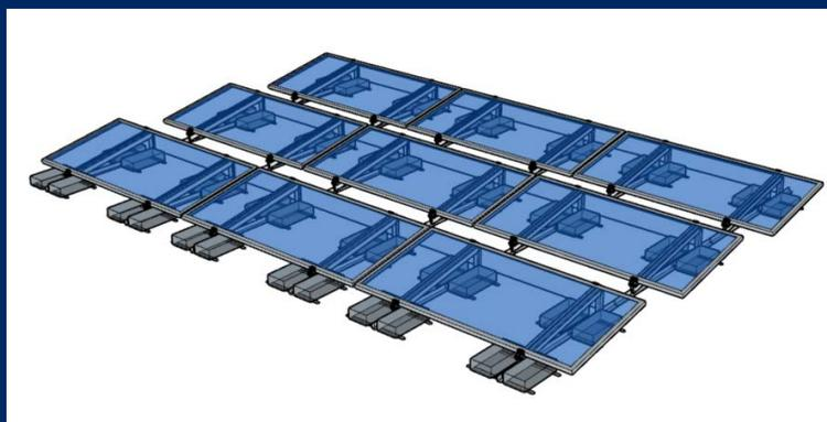
La **estructura triangular continua "Sierra Nevada"** se utiliza para fijar una numerosa cantidad de módulos FV sobre una superficie horizontal de grandes dimensiones. Posiciona los módulos con una inclinación de entre **10° y 15°** con respecto a la cubierta.
