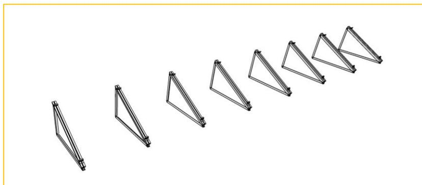
\*Siempre colocar 2 triángulos por cada módulo, separados entre 1000-1150 mm
