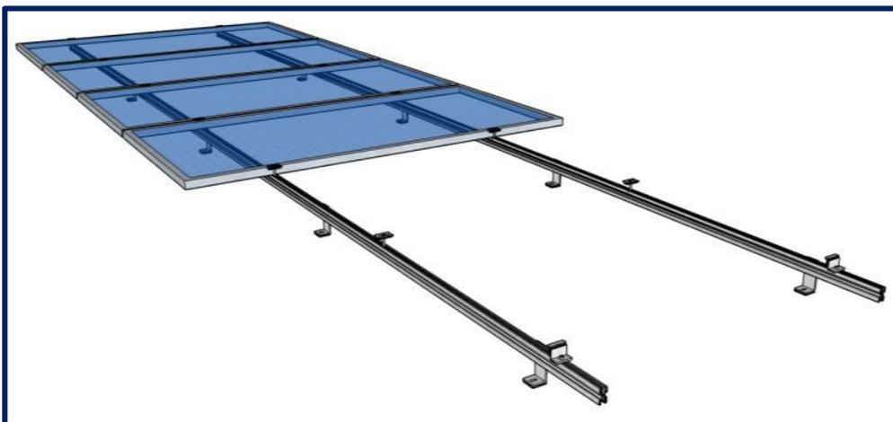
Ilustración 17. Subestructura coplanar.
